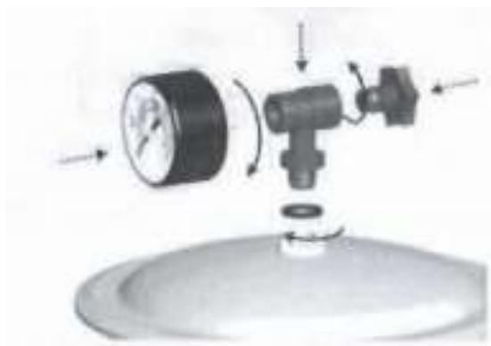
Montáž manometra (ventil s bočným pripojením)
