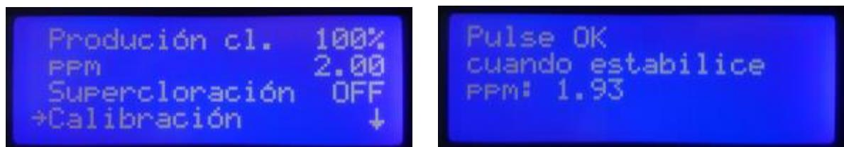
C: Pomocí šipek upravte zobrazenou hodnotu na displeji stanice dle hodnoty naměřené externím fotometrickým testerem. Finálně potvrďte tlačítkem OK.
