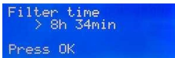
Pokud na konci dne jednotka vyhodnotí, že filtrační čerpadlo běželo kratší dobu, než bylo doporučeno pro optimální hygienické zabezpečení bazénové vody, zobrazí se na displeji varovné hlášení.
