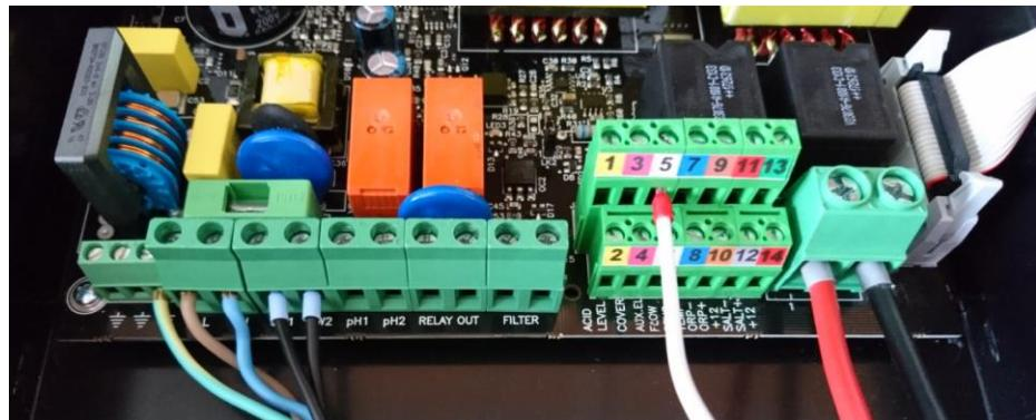
J4: Připojení cely (nezáleží na polaritě / automat. čištění = změna polarity)
