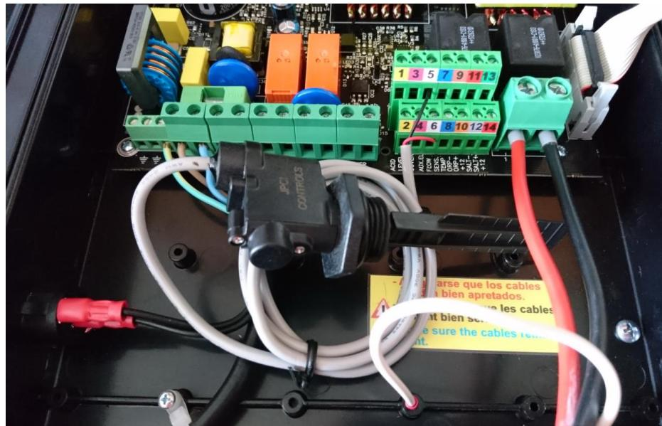
J4: Připojení cely (nezáleží na polaritě / automat. čištění = změna polarity)
