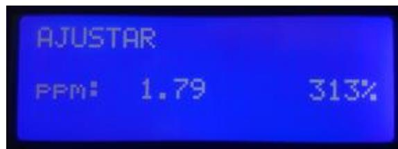
D: Vratíte se na výchozí displej a zkontrolujte, že aktuálně měřená hodnota volného chloru odpovídá tomu, co jste právě do stanice zadali v rámci kalibrace.
