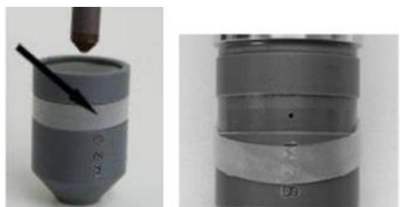
4) Našroubujte krytku zpět na tělo sondy. Přebytečný elektrolyt spolu se vzduchem bude vycházet uvolněnou dírkou (viz předchozí bod). K očištění/otření přebytečného elektrolytu použijte papírový ubrousek nebo čistou tkaničku.
