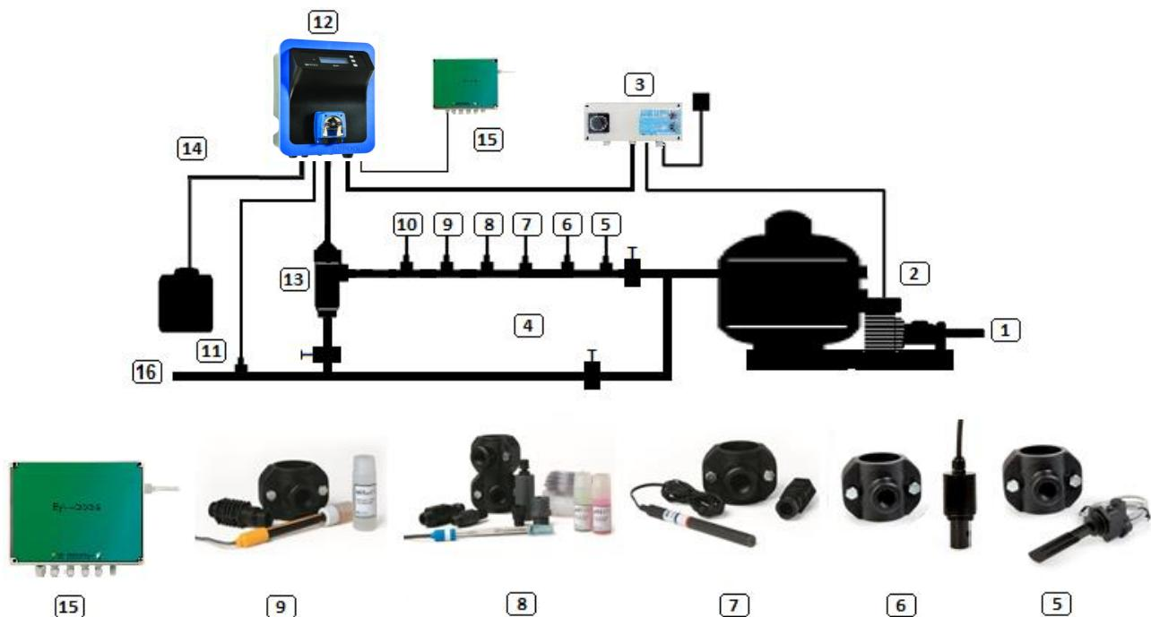
**Vstupní a výstupní napojení cely je provedeno tak, aby bylo možné lepení na PVC potrubí o průměru 50mm. Lze použít i jiné velikosti potrubí, musí ale být vždy instalovány pomocí vhodného příslušenství / redukcí.**
