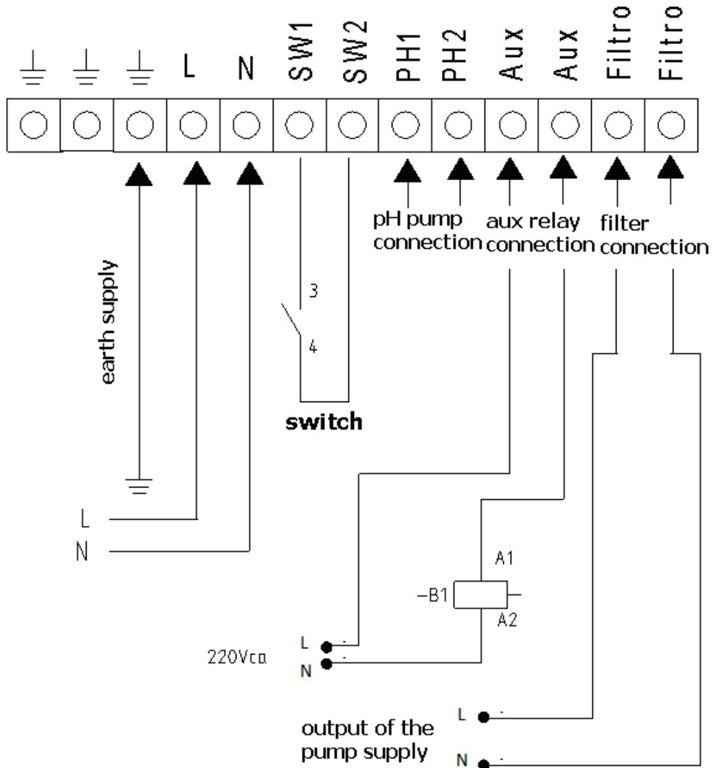
Zkontroluje si, že je jednotka nakonfigurována (3.4.2.1) / čerpadlo zapojeno na režim řízení „**START-STOP**“.
