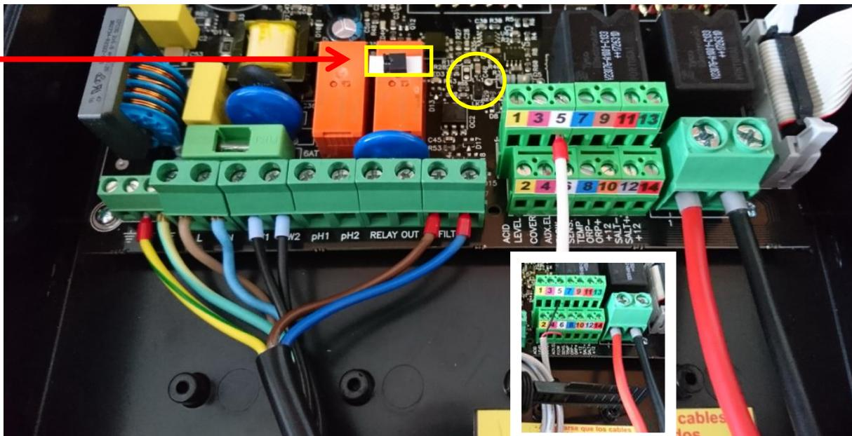
FILTER (L,N) – napěťové propojení (230V) – využití signálu paralelně s recirkulačním čerpadlem
