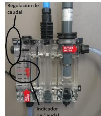
4) Pro provedení kalibrace sondy FCL je nutné mít externí měřící zařízení (optimálně fotometrický tester). Samotná kalibrace spočívá v tom, že analýzou DPD-1 změříme fotometricky koncentraci chlóru ve vodě, kterou pak zadáme do jednotky.
